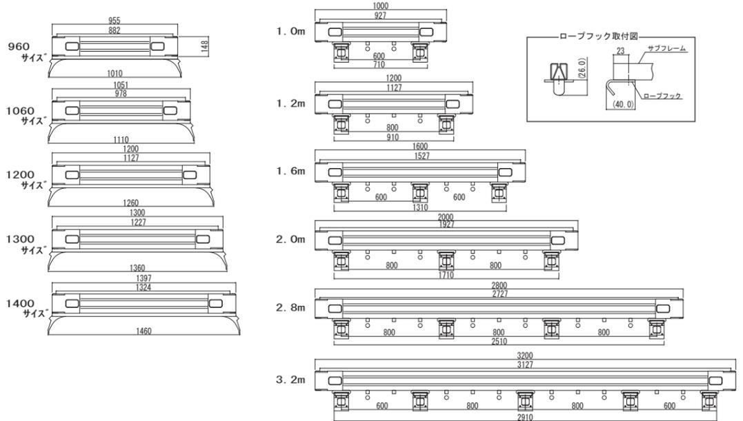
前後・左右のフレームをステンレス製の一体化とした、シリーズ中、最もタフな業務用ルーフラックです。積荷の固定に便利なロープフックを標準装備し、ロユースにお応えします。
